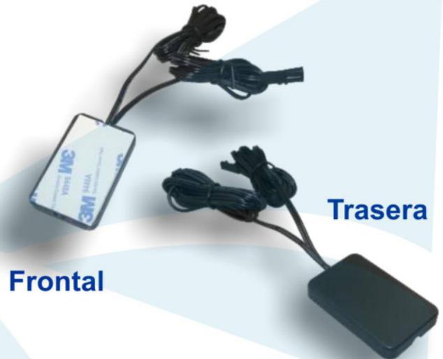
Interruptor capacitivo con luz azul\*, especialmente indicado para su aplicación en espejos. Se coloca en la parte posterior mediante una cinta adhesiva 3M, y actúa cuando tocamos por la parte frontal del espejo, cambiando el estado de apagado/encendido y regulación, en el caso de que disponga de esta función.
