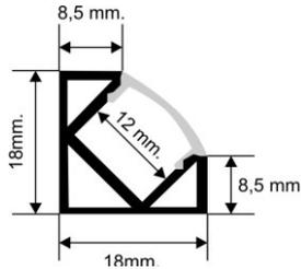
Perfil ángulo de aluminio extrusionado. Acabado anodizado plata para su uso con tiras de led de hasta 12mm.de ancho. Por su diseño es apropiado para colocar la tira de led con una inclinación de 45°.
