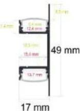
Metro de perfil de aluminio de 49mm\*17mm. Bidireccional. De pared
