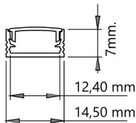
Perfil extrusionado de aluminio para tiras de hasta 10mm de ancho.
