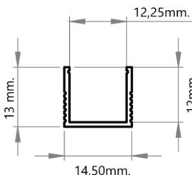
Perfil de aluminio extrusionado. Acabado anodizado plata para su uso con tiras de led de hasta 10mm.de ancho. 12mm de altura interior para conseguir una linealidad en la luz.
