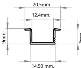
Perfil de aluminio extrusionado. Acabado anodizado plata para su uso con tiras de led de hasta 10mm.de ancho. Lleva 2 alas para tapar las posibles imperfecciones que se producen en las aristas de la madera al mecanizarla. Mayor altura que el modelo PF010CHZ para conseguir mayor linealidad en la luz.
