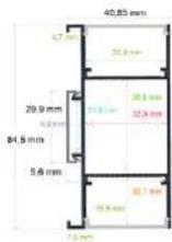
Metro de perfil de aluminio de 40.85mm\*84.5mm. Bidireccional. De pared
