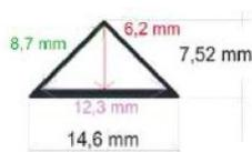
Metro de perfil de aluminio de 14.57mm\*7.4mm\*1000mm. TRIÁNGULO
