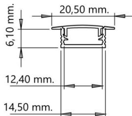
Perfil de aluminio extrusionado. Acabado anodizado plata para su uso con tiras de led de hasta 10mm.de ancho. Lleva 2 alas para tapar las posibles imperfecciones que se producen en las aristas de la madera al mecanizarla.
